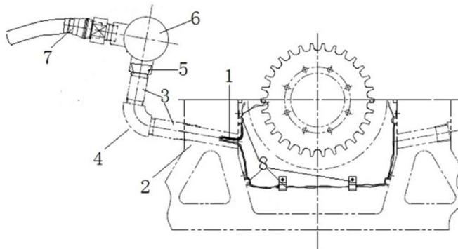
9.6 转速探头在安装时保证安全距离，无论是直接测量或者根据螺距计算，保证正对测速盘齿顶的安装间隙满足厂家或设计给出的间隙参数范围内，必须满足低转速至超速停机范围内的准确测量。为了提高转速测量回路的抗干扰能力，回路中必须并联电阻，阻值推荐  $2K\Omega$ （设计可根据实际应用调整阻值以达到最优效果），透平调试或运行时用示波器测试交流波形时，波形不能发生畸形。
